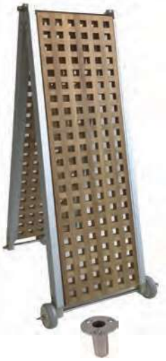
SR17182 Alüminyum Pasarella Katlanır 31x200 cm Kafesli Teak Ağırlık: 9 kg -Taşıma Kapasitesi:130 kg SR17184 Alüminyum Pasarella Katlanır 34x235 cm Kafesli Teak Ağırlık: 11 kg -Taşıma Kapasitesi:150 kg SR17188 Alüminyum Pasarella Katlanır 34x250 cm Kafesli Teak Ağırlık: 15 kg -Taşıma Kapasitesi:200 kg
